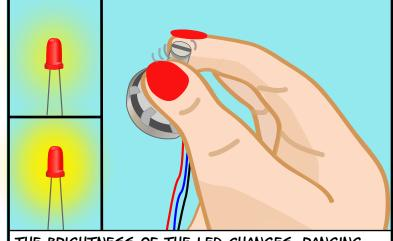
THE BRIGHTNESS OF THE LED CHANGES, RANGING FROM COMPLETELY OFF TO VERY BRIGHT AS YOU TURN THE POT.
